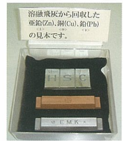
溶融飛灰から回収した亜鉛・銅・鉛のインゴットの見本です。
